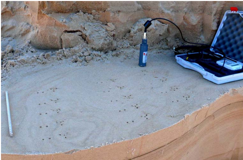
2.22. attēls. Dabīgā mitruma mērījumi Kažoku karjerā sīkgraudainas smilts atsegumā
