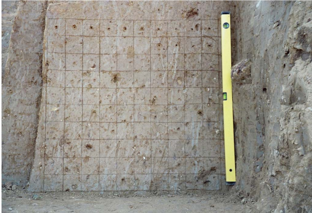
3.1. attēls. Mērījumiem sagatavotā pētījuma vieta (kubs) ar mērījumu tīklu. Mērogam pievienots līmeņrādis, tā garums ir 100 centimetri Figure 3.1. Prepared study site (cube) for measurements with measurement mesh. Level gauge is added to scale; its length is 100 centimetres
