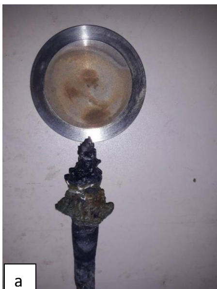
Zīm.3.3.26. a - elektrods pēc kausēšanas eksperimenta; b – analīzes paraugu noņemšanas shēma.
