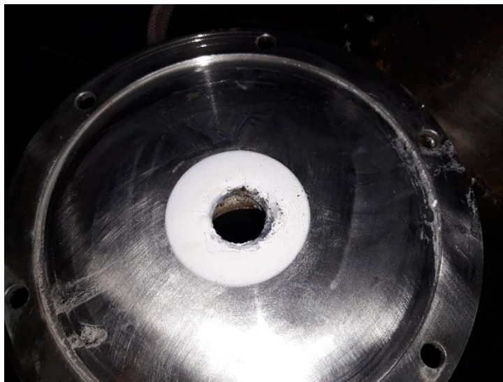
Zīm.3.3.16. Kušņi (nosēdumi) uz reaktora vāka .
