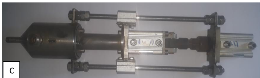
Zīm.1.3.Reaktors (A) ar papildus ieliktni (B) un dozatoru (C).
