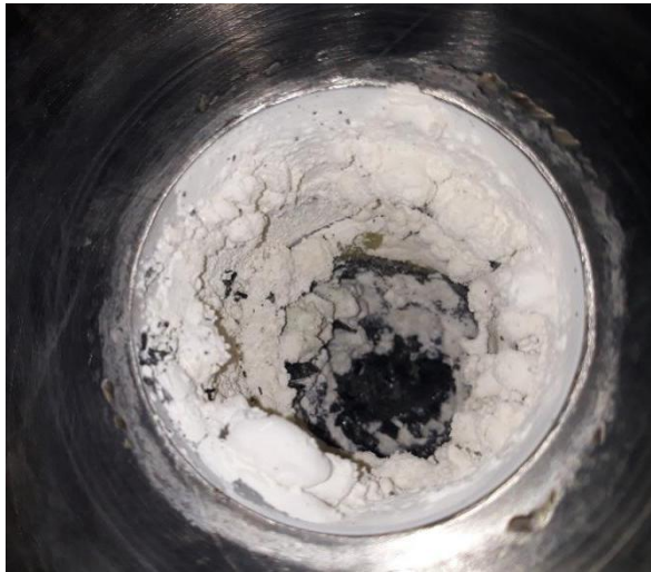
Zīm.3.3.18. Kušņi uz reaktora sienīgas virs šķidrās frakcijas pirms parauga noņemšanas.
