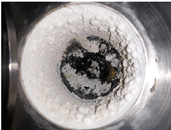
Zīm.3.3.22. Reaktora iekšpuse. Uz sānsienām kušņu nosēdumi.
