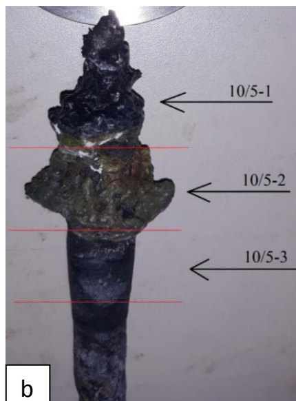
Zīm.3.3.26. a - elektrods pēc kausēšanas eksperimenta; b – analīzes paraugu noņemšanas shēma.
