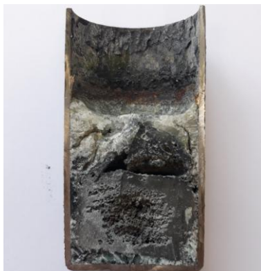
Att.2.2. Objekta 2 gareniskā griezuma attēls.
