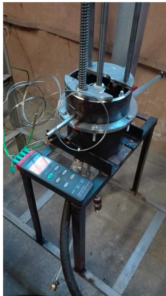
Zīm.1.5. Reaktora modulis aprīkots ar definētu termopāru skaitu.
