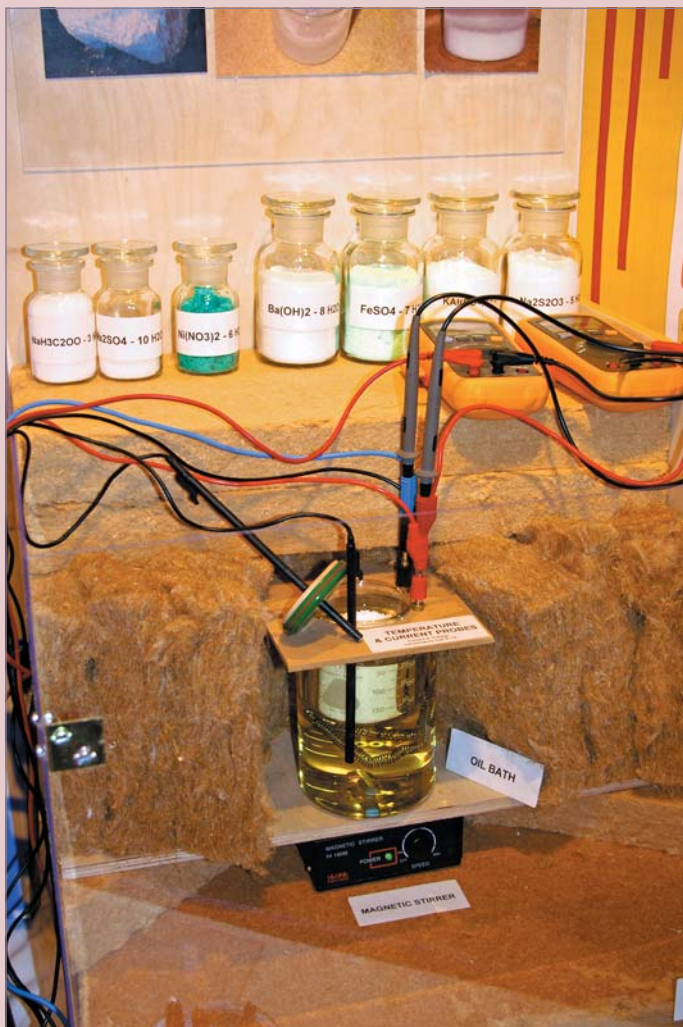
Andrē Vilmesa izveidotā iekārta sāļu hidratātū kā siltumenerģijas nesēju izpētei.
