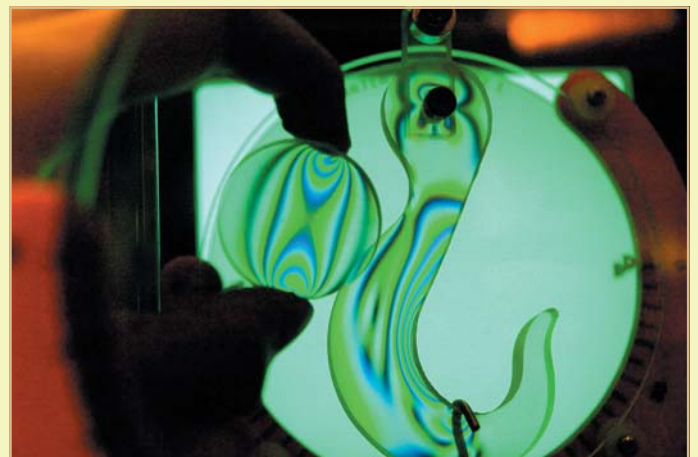
Iekārta parāda mehāniskos spriegumus nostieptā materiālā.
