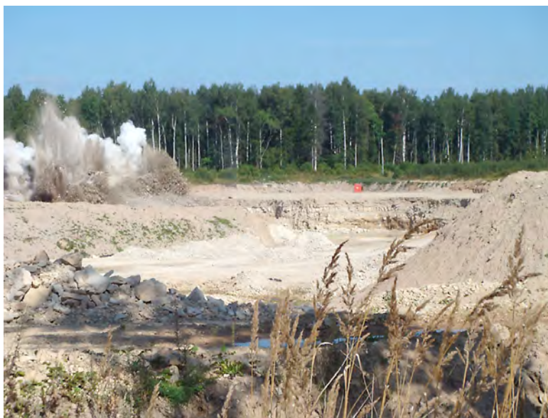
51. attēls. ležu masas uzirdināšana ar spridzināšanu Turkalnes atradnē.
