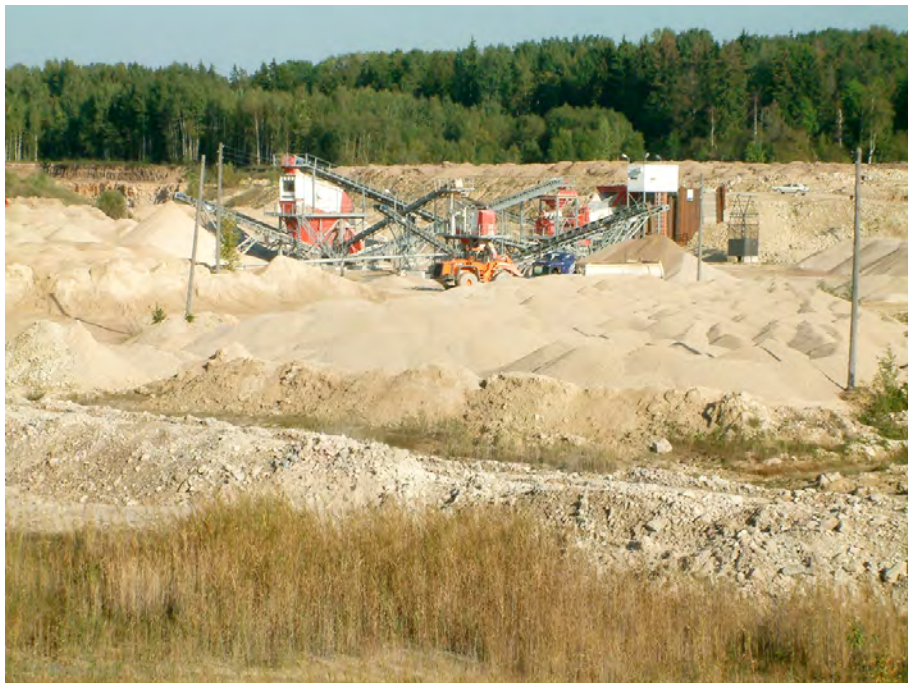
26. attēls. Dolomītu drupināšanas un sijāšanas iekārta Kranciema atradnē. Pēc izmēriem (frakcijām) sašķīrotās šķembas saber atsevišķās kaudzēs un tālāk nogādā patērētājiem, bet vissmalkākās daļiņas, kuras izbirst cauri visiem sietiem (atsijas) izmanto, lai daļēji aizpildītu izstrādāto karjeru.
