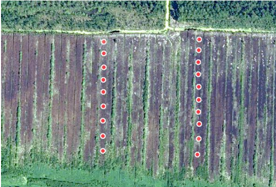
55. att. Regulāri izvietoti parauglaukumi taisnā līnijā pāri frēzlaukam, starp parauglaukumu ārējām malām – regulārs attālums.
