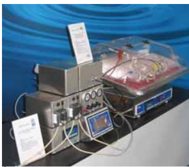
3. att. Vienreiz lietojamie un parastie laboratorijas bioreaktori a) HyClone vienreiz lietojamais bioreaktors (ap 200 l) ar termoregulējamo apvalku; b) vienreiz lietojamais bioreaktors (25 l) dzīvnieku šūnu kultūrām no BioWave; c) standarta laboratorijas fermentatori Biostat B+ (1 l) no Sartorius.
