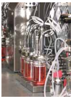
3. att. Vienreiz lietojamie un parastie laboratorijas bioreaktori a) HyClone vienreiz lietojamais bioreaktors (ap 200 l) ar termoregulējamo apvalku; b) vienreiz lietojamais bioreaktors (25 l) dzīvnieku šūnu kultūrām no BioWave; c) standarta laboratorijas fermentatori Biostat B+ (1 l) no Sartorius.
