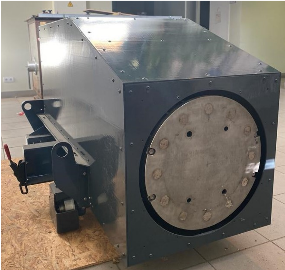
Attēls nr.4. Industriālais ierīces prototips ar 40 cm magnētisku dipolu, apgriezieni līdz 10 apgr/sek. Paredzēts darbam pie šķidra alumīnija krāsns sānu sienas alumīnija degazēšanai.
