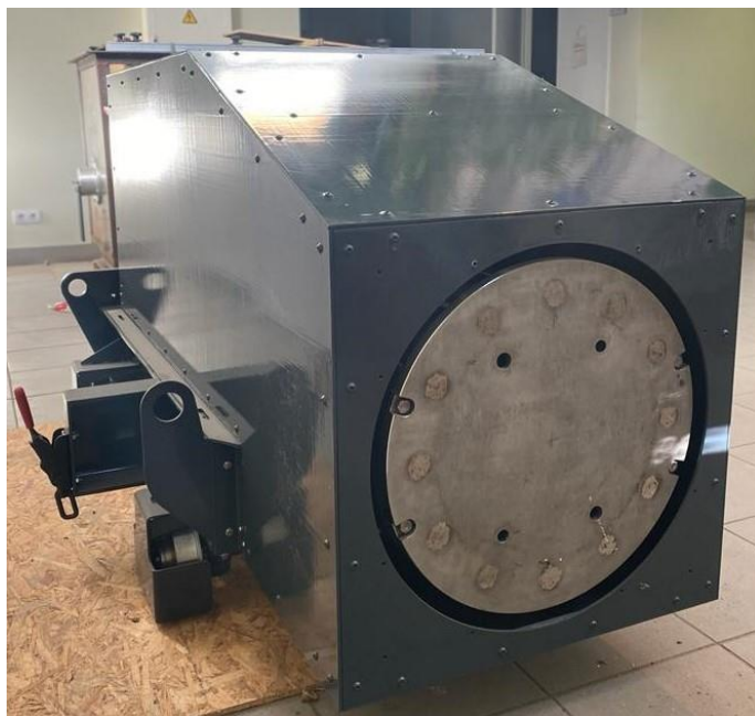
Attēls nr.2. Industriālais ierīces prototips ar 36 cm magnētisku dipolu, apgriezieni līdz 10 apgr/sek. Paredzēts darbam pie šķidra alumīnija krāsns sānu sienas alumīnija degazēšanai.
