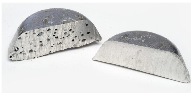
Attēls 1. Alumīnija lietņi – pa kreisi zemas kvalitātes lietnis ar gāzu ieslēgumiem, pa labi augstas kvalitātes lietnis. Avots: Darba autoru veidots attēls.
