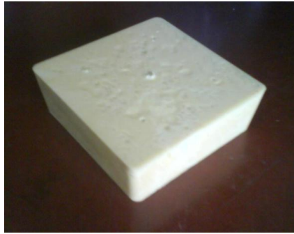
1.attēls. Cietie poliuretāna putuplasta bloks, kas uzputots slēgtā veidnē.
