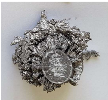
Daļēji izkūsis magnija elektrods.
