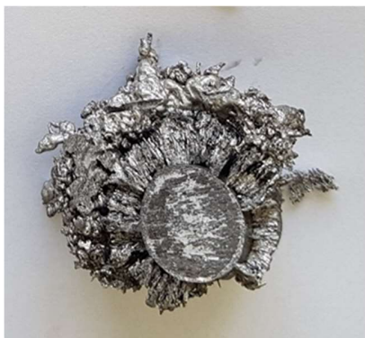
Zīm.5.2. Daļēji izkūsis magnija elektrods.
