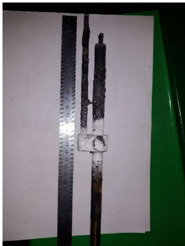
Fig. 2.10. Elektrodi un sārņu vanna kopā ar tērauda aizmetni pēc eksperimenta.
