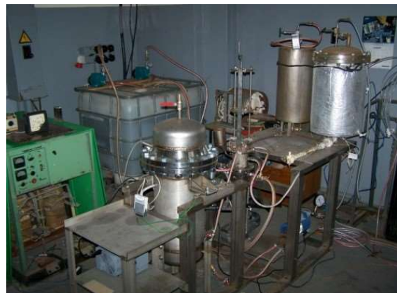
Fig.1.2. a) Titāna ražošanas eksperimentālās iekārtas skice. b) Titāna elektrosārņu ražošanas tehnoloģijas procesa prototipa stends
