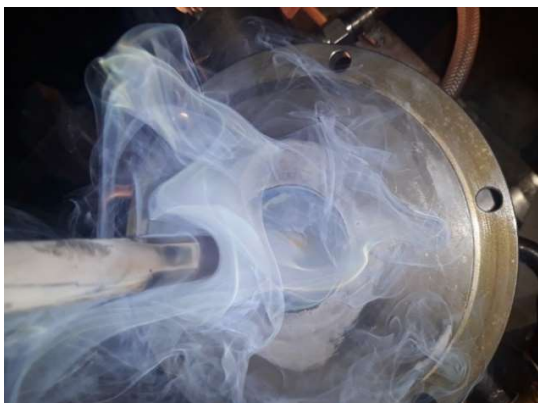
Fig. 2.1. Reaktors pēc augšējā vāka demontāžas . (Parādījušies dūmi, kas liecina, ka daļa \text{TiCl}_4 nav izreaģējusi).
