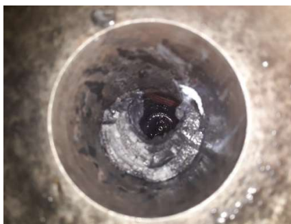
Fig. 2.2. Reaktora apakšējā daļā redzama sārņu vanna.
