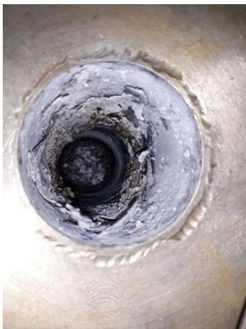
Fig. 2.8. Reaktora iekšpuse un elektrodi pēc eksperimenta.
