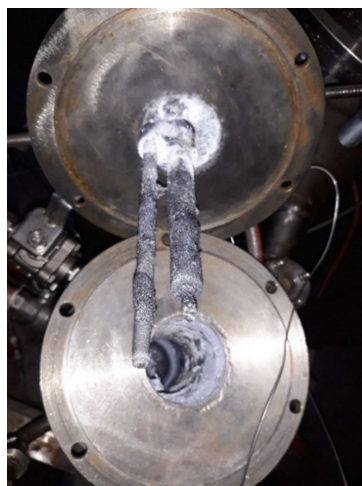
Fig. 2.8. Reaktora iekšpuse un elektrodi pēc eksperimenta.
