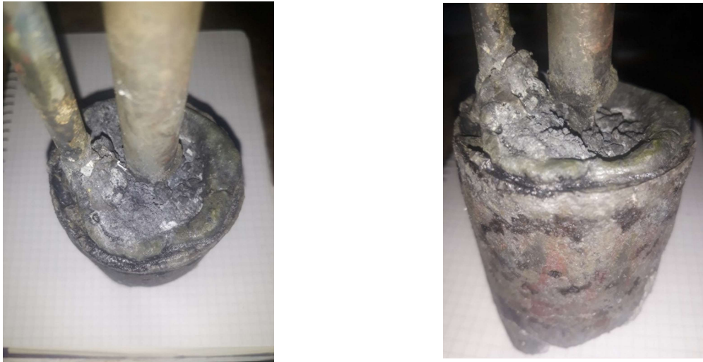
Fig. 2.5. Sārņu vanna kopā ar elektrodiem.
