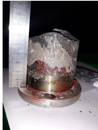
Fig. 2.10. Elektrodi un sārņu vanna kopā ar tērauda aizmetni pēc eksperimenta.
