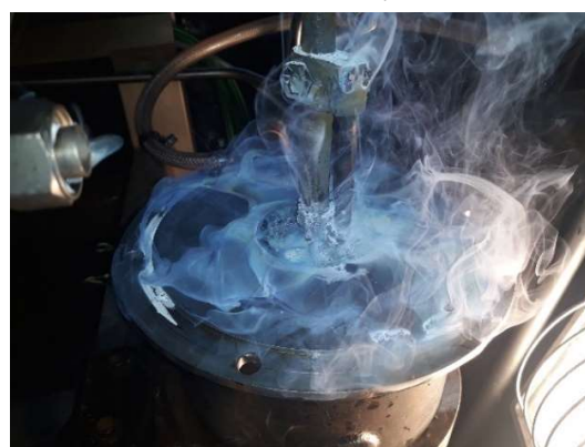
Fig. 2.1. Reaktors pēc augšējā vāka demontāžas . (Parādījušies dūmi, kas liecina, ka daļa \text{TiCl}_4 nav izreaģējusi).
