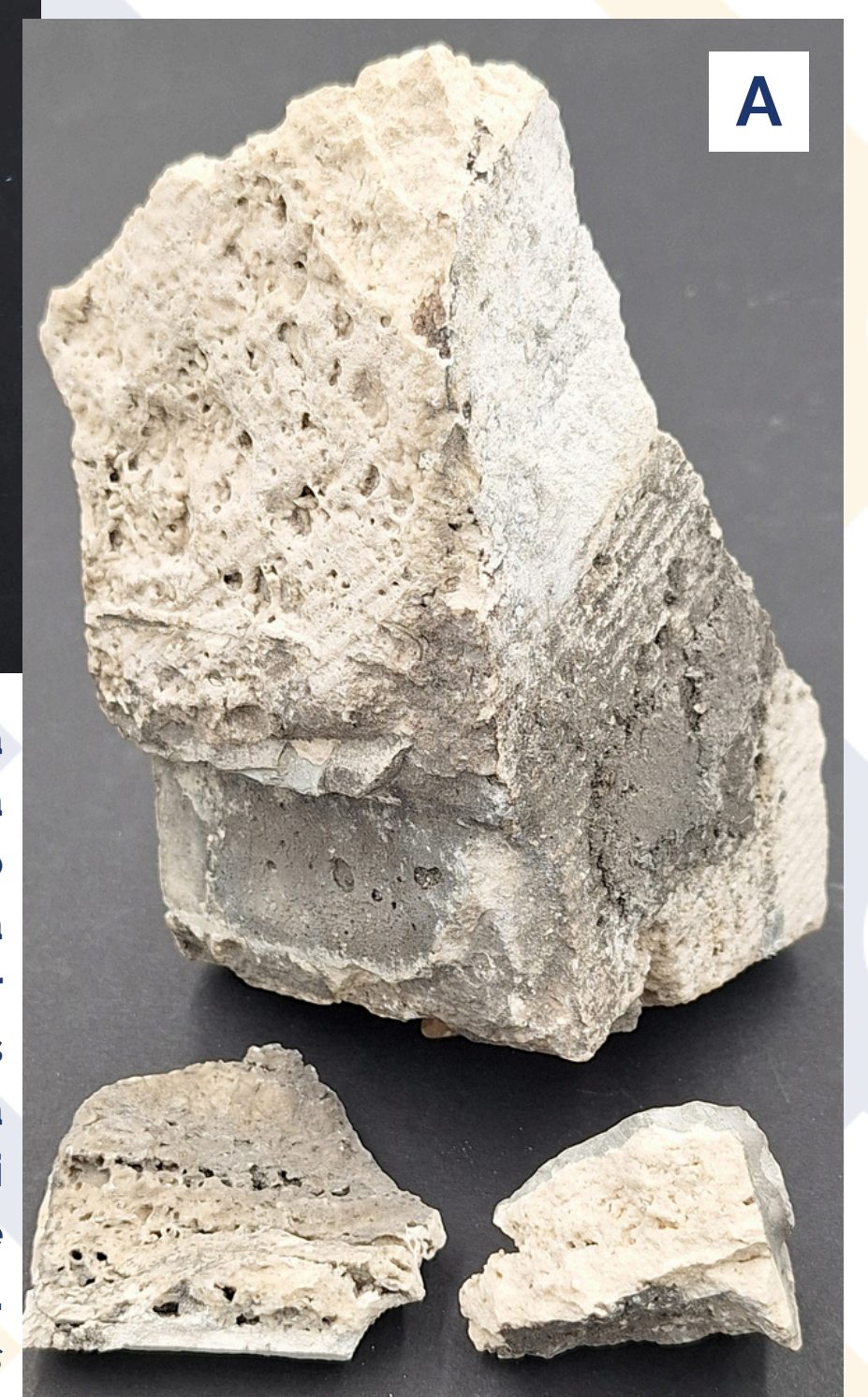
Brīvības pieminekļa travertīns (būvniecībā izmantots 1934.gadā) no (2001.gadā) restaurācijā aizvietojamā bloka (A) ar piesārņojumu un travertīns no analogiska dabīgā akmens no tās pašas Tivoli atragnes (Romās apkaime Itālijā).
