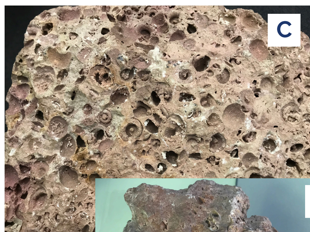
Saulkalnes sārtais kavernoza marmorveida gliemeždolomīts (A, B-detaļa) no Vecrīgā sagrautas Viduslaiku celtnes pagrabtelpām blakus Melngalvju namam un analogiska dolomīta tipa aizvietošanai izmantojamais Rīgas celtnēs no Biržu-Pūteļu dolomīta atragnes (C). LU Muzeja krājums
