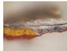
Abb. 03: Querschnitt 1. Rot-Beize Maltschichten, darauf eine blaue Schicht, darüber: sehr dicke weiße Schichten mit schwarzer Schicht. LM
