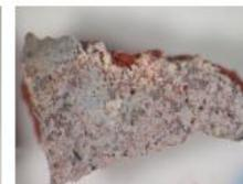
Abb. 02: Zwischenschicht (anderer Partikel), Auf dem Ziegelrot legen eine weiße und eine blaue Schicht, beide sind auffallend porrenreich. LM
