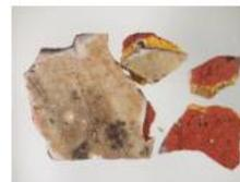
Abb. 01: Probenbereichen (Ileka) und -unterselten (realtie). Oben: dicke weißliche und bräunliche Schicht, Unterseite: ziegelrot. LM
