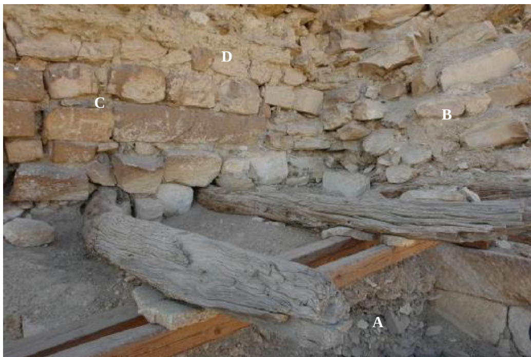
4.29. attēls. Dažādie saistvielu tipi, kas izmantoti Džosera piramīdas celtniecībā, austrumu fasādē. Apzīmējumi: A- mastabas daļa (AO); B- saistviela senākās piramīdas daļā (ALR); C- jaunākās piramīdas apdares bloku saistviela (ALR-SL); D- jaunākās piramīdas iekšējā aizpildījuma saistviela (SL). Apzīmējumus skatīt 5.2. tabulā.
