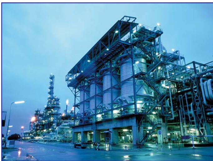
4. att. Shell kompānijas rūpnīca pie Bintulu pilsētas Malaizijā no dabasgāzes ražo šķidros ogļūdeņražus.
