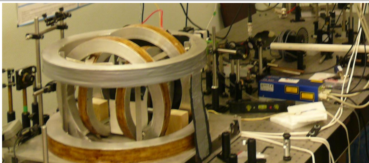
2.attēls. Eksperimentālā iekārta ar iespēju ievadīt gaismu ar 45^\circ leņķi starp lāzera starojuma elektriskā lauka vektoru un magnētiskā lauka vektoru.
