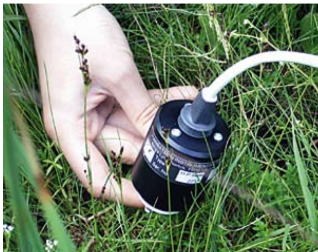
Hlorofila fluorescences nedestruktīvā analīze jūrmalas pienzāles ( Glaux maritima ) augiem ar nepārtrauktās darbības fluorometru Handy PEA, Hansatech (I. Druvas-Lūsītes foto)
